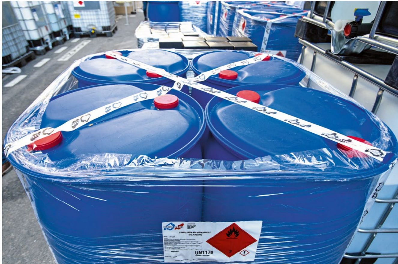
Kenntnismangel: Gefahrgutkennzeichnung auf der Folie statt auf den Versandstücken.
